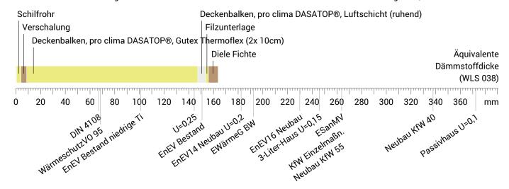
Raumluft: 20,0 °C / 50% Dicke: 27,8 cm Unbeheizter Raum: -5,0 °C / 80% sd-Wert: 3,5 m Gewicht: 61 kg/m² Oberflächentemp.: 17,7 °C / -4,8 °C Wärmekapazität: 93 kJ/m²K
