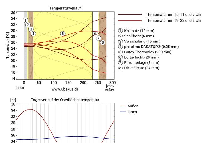
**Obere Abbildung:** Temperaturverlauf innerhalb des Bauteils zu verschiedenen Zeitpunkten. Jeweils von oben nach unten, braune Linien: um 15, 11 und 7 Uhr und rote Linien um 19, 23 und 3 Uhr morgens.
